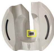
**Abbildung 4** Kontaktpunkte an der Akkuladestation des IS 3800W Handstücks
