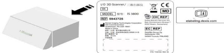
Abbildung 15 Kennzeichnung am IS 3800 Scanner
